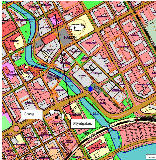
Figur 7. Mätsträcka för DOAS mätningarna i Falun. Utrustningen sitter ca 20 meter ovanför markplan och mätsträckan är ca 435 meter.
